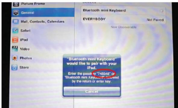
Schritt 4: Geben Sie das Passwort ein und drücken Sie zum Beenden des Verbindungsvorgangs die Schaltfläche „Enter“. Nun können Sie die Bluetooth®-Tastatur zur Texteingabe für ein iPad verwenden.
