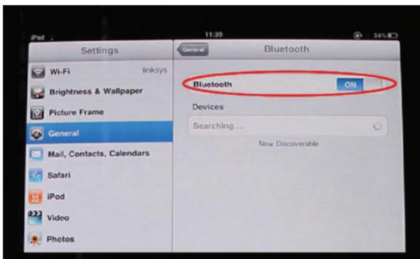
Schritt 3: Die Tastatur sucht nach dem Einschalten der Bluetooth®-Funktion automatisch nach Bluetooth®-Geräten. Anschließend findet das iPad das Gerät „Bluetooth® mini Keyboard“. Tippen Sie auf dieses Gerät und es verbindet sich. Dabei wird ein Passwort angezeigt.
