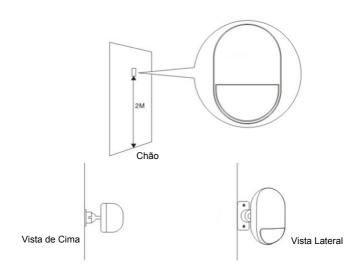
Fixe o detetor no suporte e altere o ângulo e a distância de deteção através do ajuste da altura da instalação e do suporte. Recomendase que a instalação seja feita a uma altura de 2 metros do chão.
