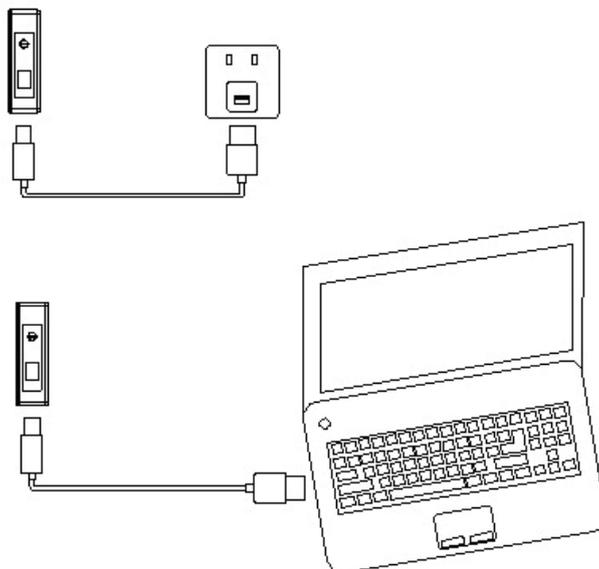
**Importante:** La prima volta, ricaricare il caricabatteria 31890 per 10 ore prima di utilizzarlo per il normale uso. Le volte successive, l'operazione di ricarica richiederà circa 6 ore.
