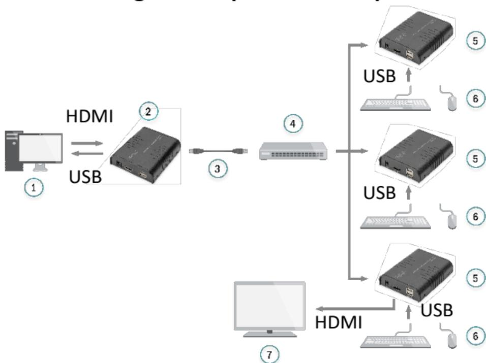
Grazie all'utilizzo di uno switch/router di rete, di un trasmettitore verso svariati ricevitori si realizza una funzione extender e splitter.
