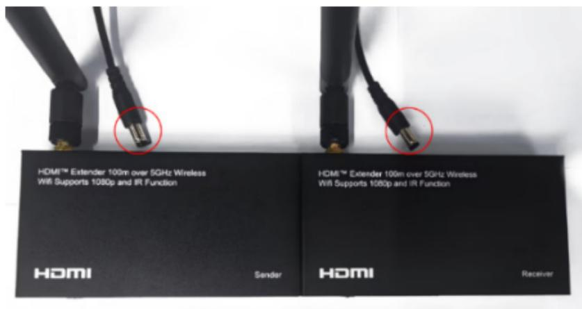
**Passaggio 8:** Collegare il trasmettitore e il ricevitore (1,2,3,4) all'alimentazione, quindi collegare il cavo HDMI con "INPUT" del trasmettitore al dispositivo sorgente HDMI e "OUTPUT" del trasmettitore (1,2,3,4) al monitor o alla TV.
