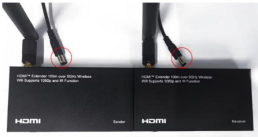
**Schritt 8:** Schließen Sie den Sender und den Empfänger (1,2,3,4) an die Stromversorgung an, verbinden Sie dann das HDMI-Kabel mit dem „INPUT“ des Senders mit dem HDMI-Quellgerät und den „OUTPUT“ des Senders (1,2,3,4) mit dem Bildschirm oder Fernseher.
