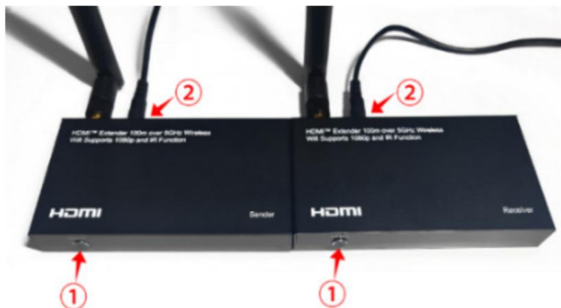
**Schritt 3:** Wenn die Status-LED des Empfängers (1,2,3,4) häufig blinkt, bedeutet dies, dass der Anpassungsmodus aktiviert ist.
