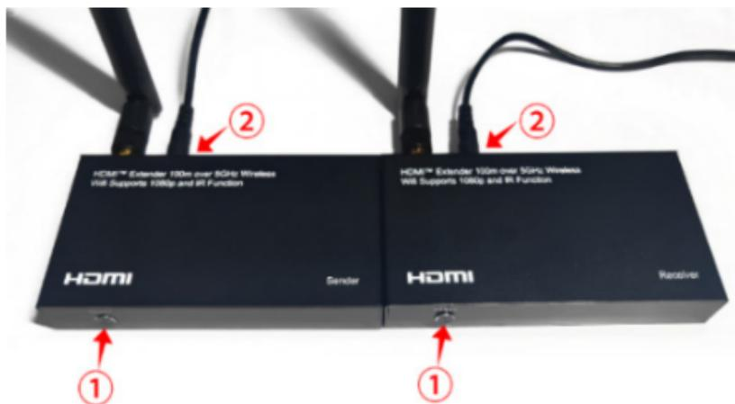
**Passaggio 3:** Se il LED di stato del ricevitore (1,2,3,4) lampeggia frequentemente, significa che la modalità di adattamento è attivata.
