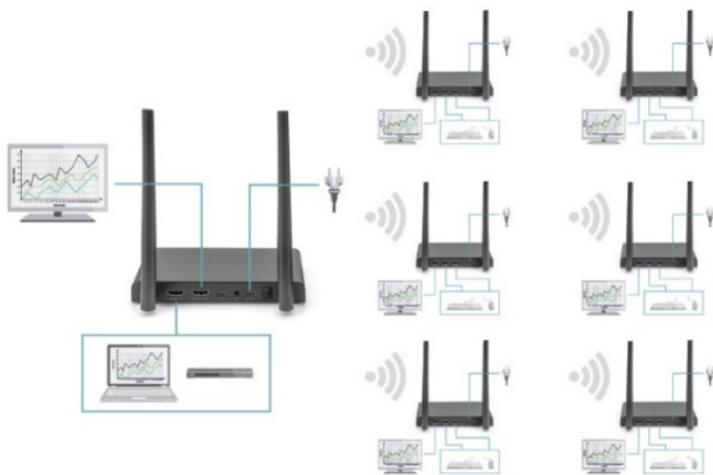
El Kit extensor HDMI KVM 4K inalámbrico también es compatible con la función Multicast; es decir, que la transmisión de vídeo desde un emisor se efectúa simultáneamente por streaming hacia un grupo de receptores. Cada emisor soporta un máximo de 4 receptores. Al comprar un nuevo receptor, el emisor detectará automáticamente el segundo receptor una vez que lo haya encendido y transmitirá el vídeo a este.
