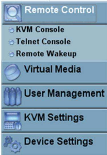
Die Remote-Konsole besteht aus dem umgeleiteten Bildschirm, Tastatur und Maus des entfernten Host-Systems, das der IP-KVM steuert. Das Remote-Konsolefenster ist ein Java-Applet, das eine eigene TCP-Verbindung zum IP-KVM aufbaut.
