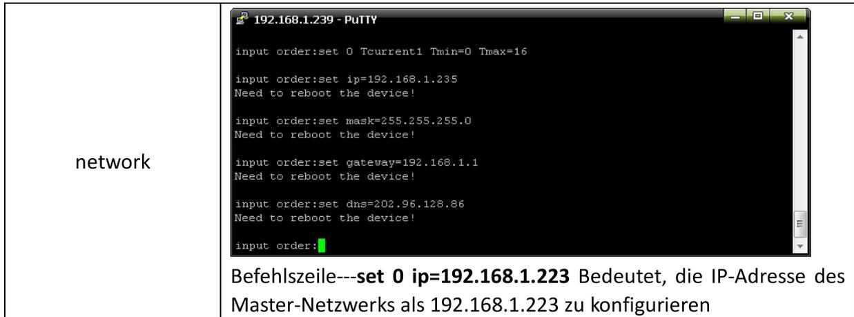
3.2.3.6 Netzwerk-Befehl: Prüfen Sie die Netzwerkkonfigurationsinformationen, wie IP-Adresse, Subnetzmaske, Standard-Gateway, Haupt-DNS, Ersatz-DNS
