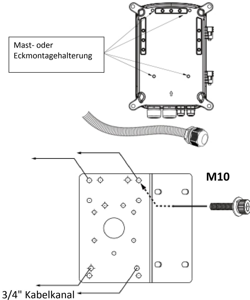
Die Montagebohrung ist nachstehend dargestellt. Gleiche Montagebohrung für alle Mast- und Eckmontagehalterungen.
