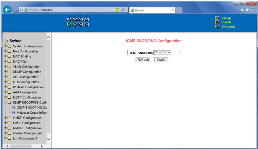
Abbildung 52: IGMP SNOOPING-Konfigurationsseite
