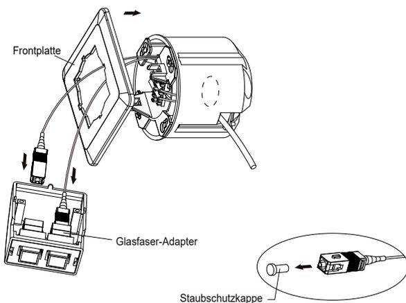
**6** Schrauben Sie das Glasfasermodul fest, bringen Sie das Anschlusskennzeichnungspapier/den Schutzdeckel an und schrauben Sie die Lochkappe auf, um die Installation abzuschließen.
