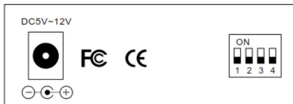
Табл. 4: Задняя панель для оптического медиаконвертера
