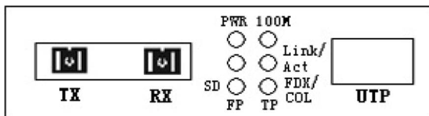
Fig. 2: Panneau avant pour la conversion double fibre
