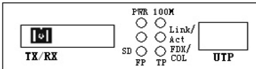
Abb. 3: Vorderseite des Einfach-Glasfaser Medienkonverters
