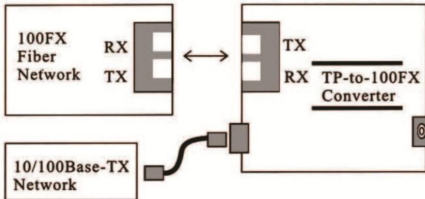
Abb. 1 Standard-Netzwerkverbindung
