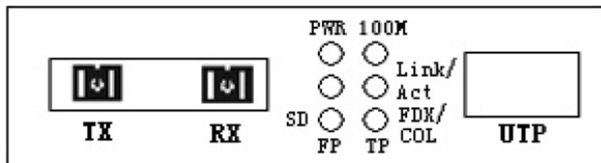
Abb. 2: Vorderseite des Doppel-Glasfaser Medienkonverters
