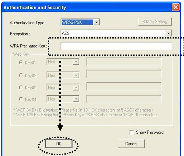
3. Wenn der drahtlose Zugangspunkt mit einer Verschlüsselung arbeitet, geben Sie eine WEP-Passphrase oder einen „WPA Preshared Key“ ein. Fragen Sie den Eigentümer des gewünschten drahtlosen Zugangspunktes danach und geben Sie den korrekten Schlüssel ein. Klicken sie dann auf „OK“. Wenn die Zeichenfolge hier falsch eingegeben wurde, ist eine Anwahl am drahtlosen Zugangspunkt nicht möglich.
