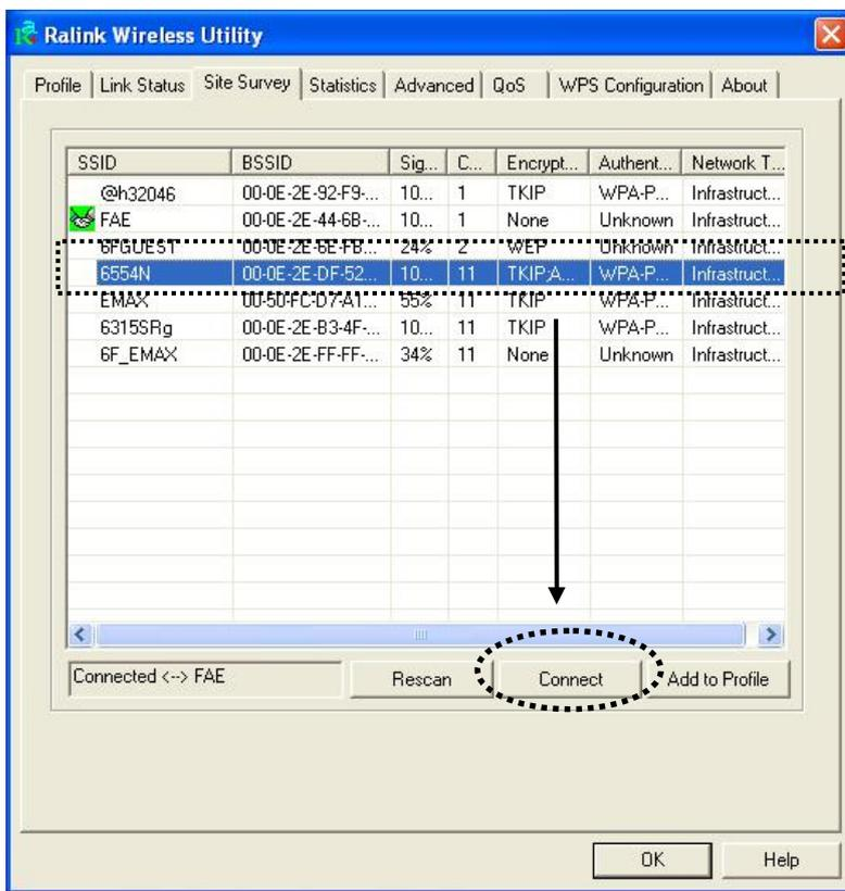
2. Das Konfigurationsdienstprogramm sucht selbsttätig nach drahtlosen Zugangspunkten; alle gefundenen Zugangspunkte werden in der Tabelle angezeigt. Wählen Sie bitte einen Zugangspunkt, mit dem Sie sich verbinden lassen möchten, und klicken Sie auf „Connect“.
