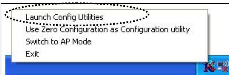
1. Nach Abschluss der Installation wird in der rechten unteren Ecke des Fensters ein Symbol für das Dienstprogramm für die drahtlose Konfiguration angezeigt. Klicken Sie mit der rechten Maustaste auf dieses Symbol und wählen Sie „Launch Config Utilities“.
