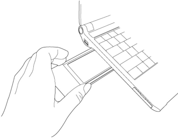
1. Die WLAN-Karte in einen freien PCIe-ExpressCard-Steckplatz Ihres Computers stecken. Die Karte kann sowohl bei ein- als auch bei ausgeschaltetem Computer eingesetzt werden.
