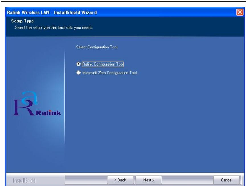
4. Sie können nun das Dienstprogramm wählen, mit dem Sie die WLAN-Karte konfigurieren möchten. Wir empfehlen, „Ralink Configuration Tool“ zu wählen; dieses Tool gewährt vollen Zugriff auf alle Funktionen dieser WLAN-Karte. Möchten Sie jedoch lieber das Konfigurationstool für drahtlosen Betrieb von Windows XP or Vista verwenden, wählen Sie bitte „Microsoft Zero Configuration Tool“. Dann auf „Next“ klicken.
