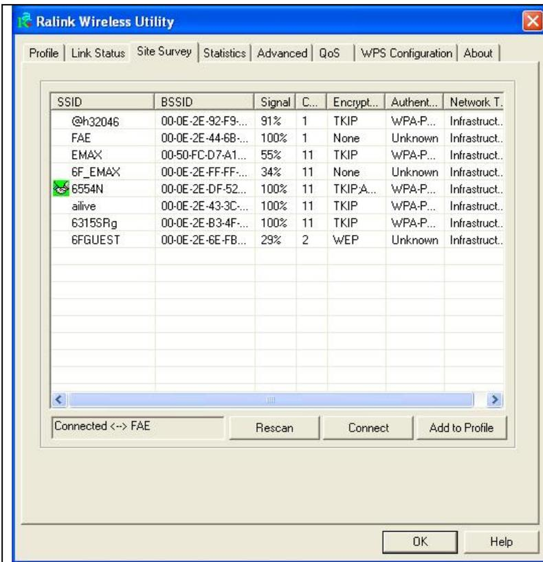
4. Ist die Anwahl am drahtlosen Zugangspunkt erfolgreich, wird dies links unten im Fenster des Dienstprogramms für die drahtlose Konfiguration angezeigt („Connected“). Zum Beenden des Programms auf „OK“ klicken.
