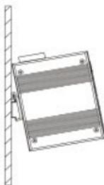
Platzieren Sie daraufhin von der Mitte aus auf beiden Seiten nacheinander die Schrauben an der Führungsschiene.
