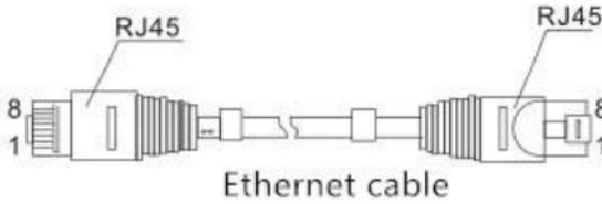
RJ45 port otomatik MDI/MDI-X işlemini destekler, PC'ye veya sunucuya bağlanmak için düz bir hat kullanabilir, diğer anahtarlara veya Hub'lara bağlanabilirsiniz. Geçiş hattı (MDI) için 1, 2, 3, 4, 5, 6, 7, 8 numaralı pinler bağlantıya karşılık gelir.
