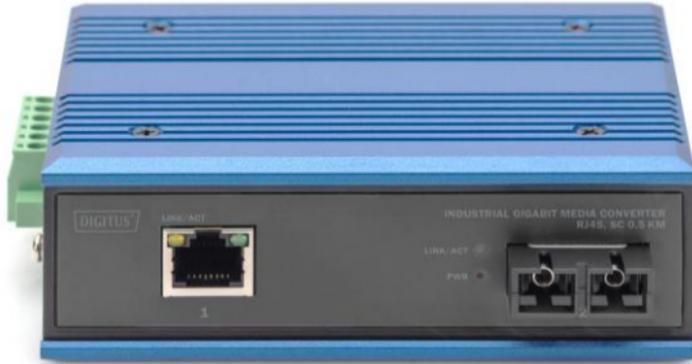
**Ön panel:** Portta bulunan turuncu ışık, bağlantı kurulduğunda ve veri iletimi yanıp sönerken yanan LINK ışığıdır. Yeşil ışık, yalnızca anahtar portu PD cihazlarına güç sağladığında yanan PoE ışığıdır (yalnızca DN-652104-1 PoE'yi destekler) güç bağlantısı olduğunda güç göstergesi yanar.
