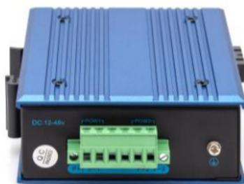
**Parete laterale:** P1 e P2 indicano il numero di morsetti di collegamento, P+1 e P-1 rappresentano i poli positivi e negativi da collegare; vite di messa a terra utilizzata per la messa a terra dell'apparecchiatura.
