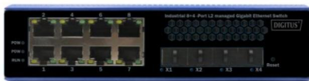
**Pannello frontale:** La spia arancione sulla porta è la spia LINK che si accende quando è stato creato il collegamento e lampeggia per la trasmissione dati. La luce verde è la luce PoE che si accende solo quando la porta dello switch alimenta i dispositivi PD; l'indicatore di alimentazione si accende quando è presente un collegamento per la fornitura di alimentazione.
