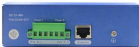
**Parete laterale:** P1 e P2 indicano il numero di morsetti di collegamento, P+1 e P-1 rappresentano i poli positivi e negativi da collegare; vite di messa a terra utilizzata per la messa a terra dell'apparecchiatura.
