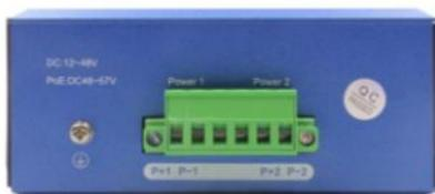
**Panel lateral:** P1 y P2 representa el número de bornes de conexión, P+1 y P-1 representan los polos positivos y negativos a conectar; tornillo de puesta a tierra usado para la puesta a tierra del equipo.
