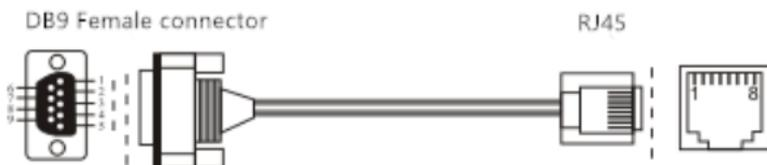
**Conexión de consola: velocidad de transferencia 115200**
