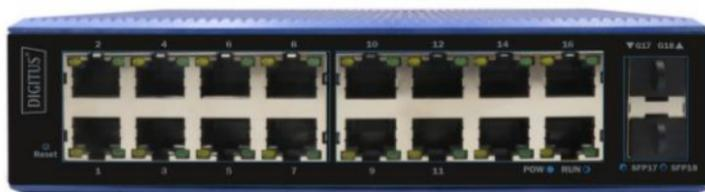
**Face avant:** Le voyant orange sur le port est le voyant LINK, il s'allume lorsque la connexion est établie et clignote lors de la transmission des données. Le voyant vert est le voyant PoE, il ne s'allume que lorsque le port du commutateur alimente les appareils alimentés; le voyant d'alimentation s'allume lorsqu'il fournit du courant.
