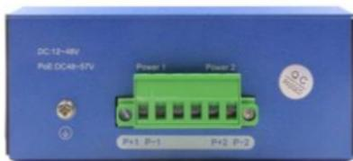
**Panneau latéral:** P1 et P2 correspondent au nombre de bornes de connexion, P+1 et P-1 correspondent respectivement aux pôles positif et négatif à connecter; vis de mise à la terre utilisée pour la mise à la terre de l'équipement.
