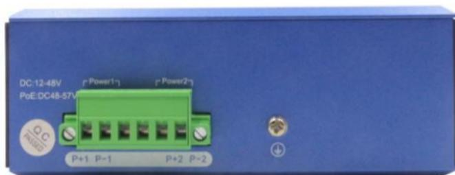
**Panel lateral:** P1 y P2 representa el número de bornes de conexión, P+1 y P-1 representan los polos positivos y negativos a conectar; tornillo de puesta a tierra usado para la puesta a tierra del equipo.
