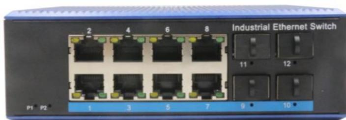
**Panel frontal:** La luz de color naranja en el puerto es la luz LINK que está encendida cuando la conexión está establecida y parpadea durante la transferencia de datos. La luz verde es la luz PoE que solo está encendida cuando el puerto del conmutador suministra energía a los dispositivos PD; el indicador de corriente está encendido cuando hay una conexión con energía.
