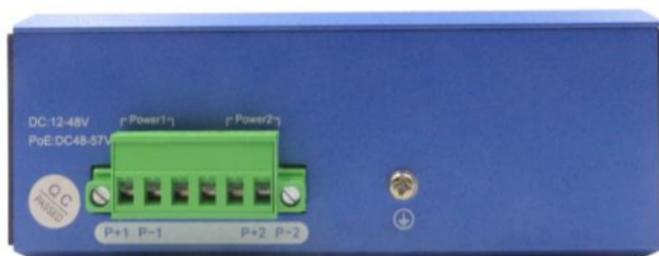
**Parete laterale:** P1 e P2 indicano il numero di morsetti di collegamento, P+1 e P-1 rappresentano i poli positivi e negativi da collegare; vite di messa a terra utilizzata per la messa a terra dell'apparecchiatura.
