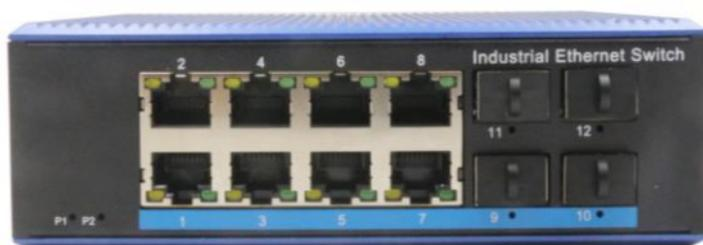
**Pannello frontale:** La spia arancione sulla porta è la spia LINK che si accende quando è stato creato il collegamento e lampeggia per la trasmissione dati. La luce verde è la luce PoE che si accende solo quando la porta dello switch alimenta i dispositivi PD; l'indicatore di alimentazione si accende quando è presente un collegamento per la fornitura di alimentazione.
