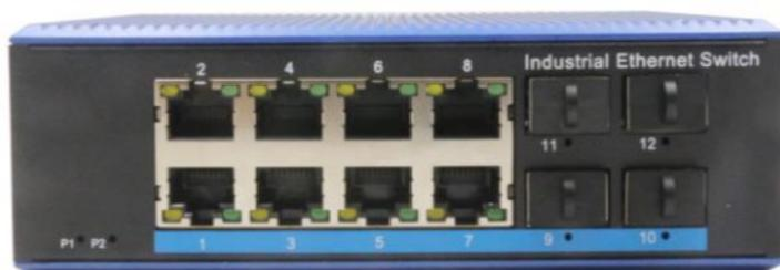
**Face avant:** Le voyant orange sur le port est le voyant LINK, il s'allume lorsque la connexion est établie et clignote lors de la transmission des données. Le voyant vert est le voyant PoE, il ne s'allume que lorsque le port du commutateur alimente les appareils alimentés; le voyant d'alimentation s'allume lorsqu'il fournit du courant.
