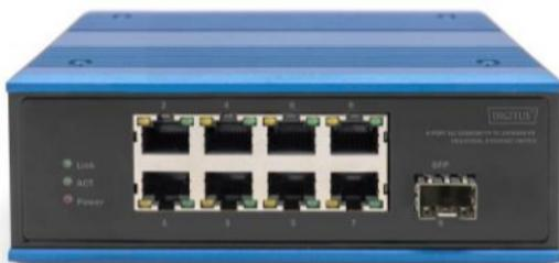
**Pannello frontale:** La spia arancione sulla porta è la spia LINK che si accende quando è stato creato il collegamento e lampeggia per la trasmissione dati. La luce verde è la luce PoE che si accende solo quando la porta dello switch alimenta i dispositivi PD (solo DN-651133/DN-651147 supportano la funzione PoE); l'indicatore di alimentazione si accende quando è presente un collegamento per la fornitura di alimentazione.
