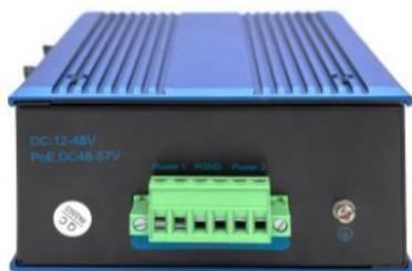
**Parete laterale:** P1 e P2 indicano il numero di morsetti di collegamento, P+1 e P-1 rappresentano i poli positivi e negativi da collegare; vite di messa a terra utilizzata per la messa a terra dell'apparecchiatura.
