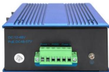
**Panneau latéral:** P1 et P2 correspondent au nombre de bornes de connexion, P+1 et P-1 correspondent respectivement aux pôles positif et négatif à connecter ; vis de mise à la terre utilisée pour la mise à la terre de l'équipement.
