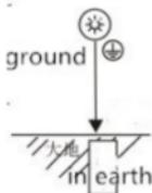
Fixez le câble de mise à la terre à la vis de mise à la terre du commutateur et veillez à ce que le dispositif de mise à la terre soit correctement connecté.
