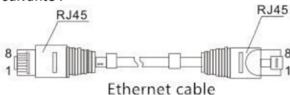
Le port RJ45 prend en charge l'auto MDI/MDI-X, vous pouvez utiliser un câble droit pour vous connecter à un PC, un serveur, à d'autres commutateurs ou hubs. Pour l'interface MDI, les broches 1, 2, 3, 4, 5, 6, 7, 8 correspondent au raccordement.
