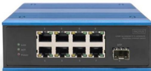
**Face avant:** Le voyant orange sur le port est le voyant LINK, il s'allume lorsque la connexion est établie et clignote lors de la transmission des données. Le voyant vert est le voyant PoE, il ne s'allume que lorsque le port du commutateur alimente les appareils alimentés (seuls les modèles DN-651133/DN-651147 prennent en charge le PoE) ; le voyant d'alimentation s'allume lorsqu'il fournit du courant.
