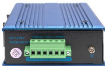
Auf der Oberseite des Gerätes befinden sich die Anschlussklemmen. Die Klemmen Power 1 und Power 2 verfügen über je einen positiven und einen negativen Pol. Seitlich befindet sich die Erdungsschraube um den Switch zu Erden.
