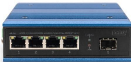
**Frontansicht:** Die gelbe LED am Anschluss ist die LINK-Anzeige, die leuchtet, wenn die Verbindung hergestellt ist, und blinkt, wenn eine Datenübertragung stattfindet.
