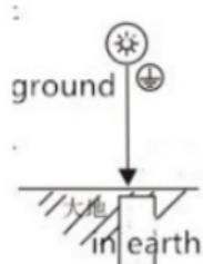
Topraklama telini anahtarın üzerindeki topraklama vidasına sabitleyerek topraklama sistemi için sağlam ve güvenilir bir bağlantı sağlayın.
