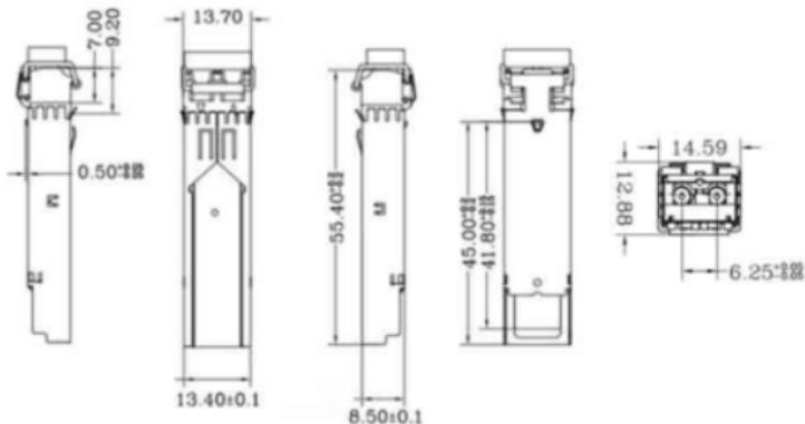
LC konektör, Gigabit, 20 km Tekli mod, Tekli fiber (DN-81020 ve DN-81021)
