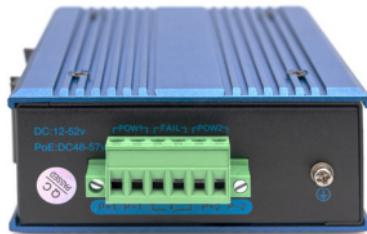
**Yan panel:** P1 ve P2 bağlantı terminallerinin numarası, P+1 ve P-1 ise sırasıyla bağlanacak pozitif ve negatif kutuplardır; Topraklama vidası ekipmanı topraklamak için kullanılır.
