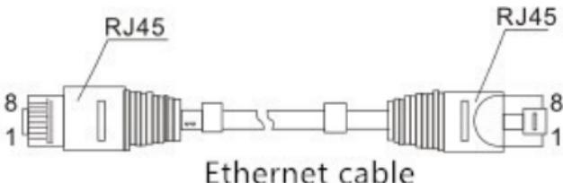
RJ45 bağlantı noktası otomatik MDI/MDI-X çalışmasını destekler, doğru hat kullanarak PC'ye veya sunucuya, diğer anahtarlarla ya da hub'lara bağlayabilirsiniz. Doğru hatta (MDI) 1, 2, 3, 4, 5, 6, 7, 8 pimleri bağlantıya karşılık gelir; bir anahtar ya da hub'in MDI-X bağlantı noktası için de çapraz hatlar kullanılır: 1-3, 2-6, 3-1, 6-2, 4-7, 5-8, 7-4, 8-5. 1000Base-T (X) pimleri aşağıdaki şekilde tanımlanır:
