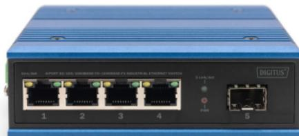
**Ön panel:** Bağlantı noktası üzerindeki sarı ışık BAĞLANTI ışığıdır; bağlantı kurulduğunda yanar ve veri iletimi sırasında yanıp söner. Yeşil ışık ise PoE ışığıdır; yalnızca anahtar bağlantı noktası PD cihazlarına güç sağlarken yanar. Güç kaynağı ile bağlantı sağlandığında güç göstergesi ışığı yanar.
