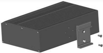
Abbildung 2-1: Schaubild zur Montage an der DIN-Schiene
