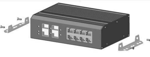
Abbildung 2-2: Schaubild zur Montage der Halterungen
