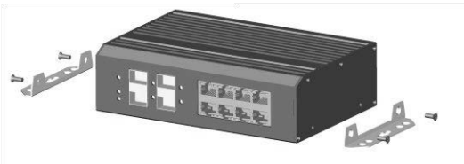
Figure 2-2 Schéma d'installation des supports
