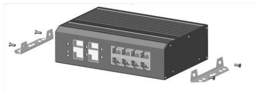
Figure 2-2 Diagramma di installazione delle staffe
