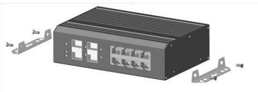
Abbildung 2-2: Schaubild zur Montage der Halterungen
