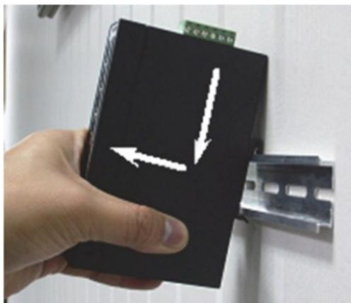
Gerät aus DIN-Hutschiene entfernen.
