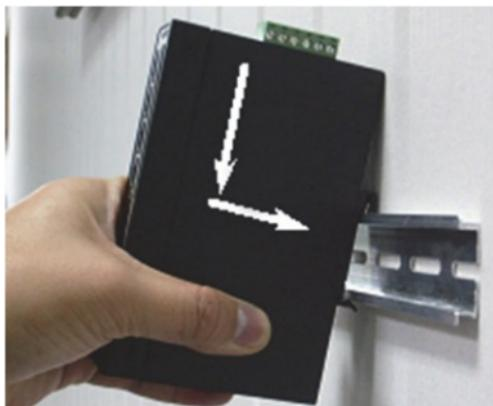
Gerät in die Hutschiene einsetzen.
