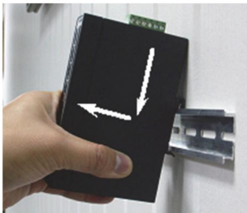
Gerät aus DIN-Hutschiene entfernen.
