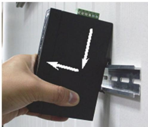
Gerät aus DIN-Hutschiene entfernen.
