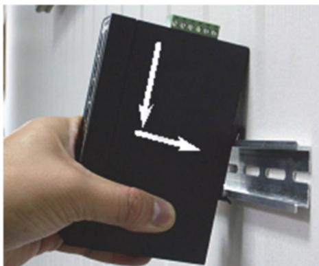
Gerät in die Hutschiene einsetzen.
