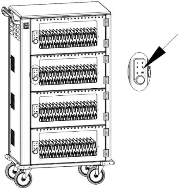
2. Coloque las tabletas según su número una tras otra en la ranura rotatoria para tabletas con el número correspondiente.
