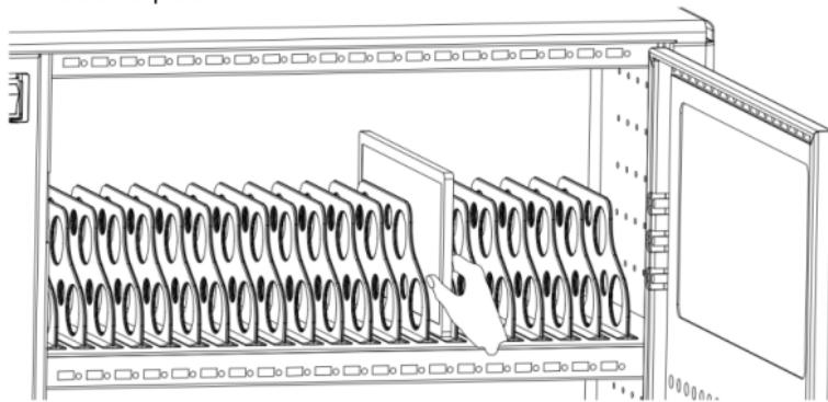
3. Verbinden Sie dabei das eine Ende des USB-Kabels mit der Ladeeinheit, das andere mit dem Port des Tablets.
