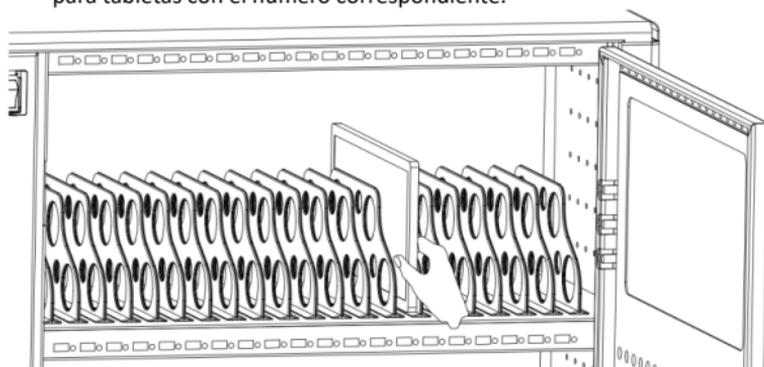
3. Los dos extremos del cable USB están conectados al puerto de carga/hub en el dispositivo y al puerto de la tableta, respectivamente.
