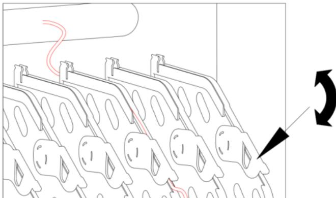
10. Coloque las tabletas o los ordenadores portátiles uno tras otro en las ranuras para tabletas (ordenadores portátiles) y conecte el correspondiente cable de datos
