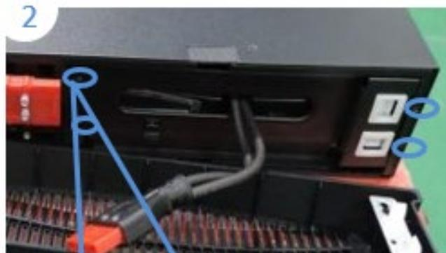
Batterieabdeckung mit Schrauben
