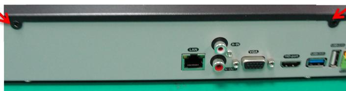
Entfernen Sie die Gehäuseabdeckung, indem Sie sie zu sich ziehen.
