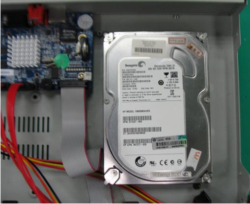
Montieren Sie die Festplatte mit dem Schrauben im NVR.
