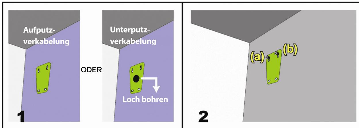
Kleben Sie den mitgelieferten Installationsaufkleber auf die Stelle, wo Sie die Kamera installieren möchten. Entsprechend Ihrer Montageumgebung bohren Sie ein Loch in der Mitte des Aufklebers für das spätere Durchführen des Strom- und Videokabels, falls notwendig.
