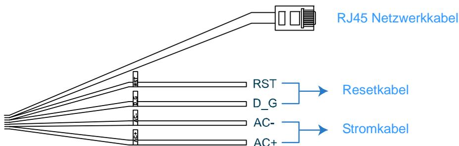
Verdrillen Sie Kamera- und Stromkabel entsprechend der Farbmarkierung (Plus an Plus und Minus an Minus, nicht das Massekabel). Dann kleben Sie die Verbindung mit Isolierband ab.
