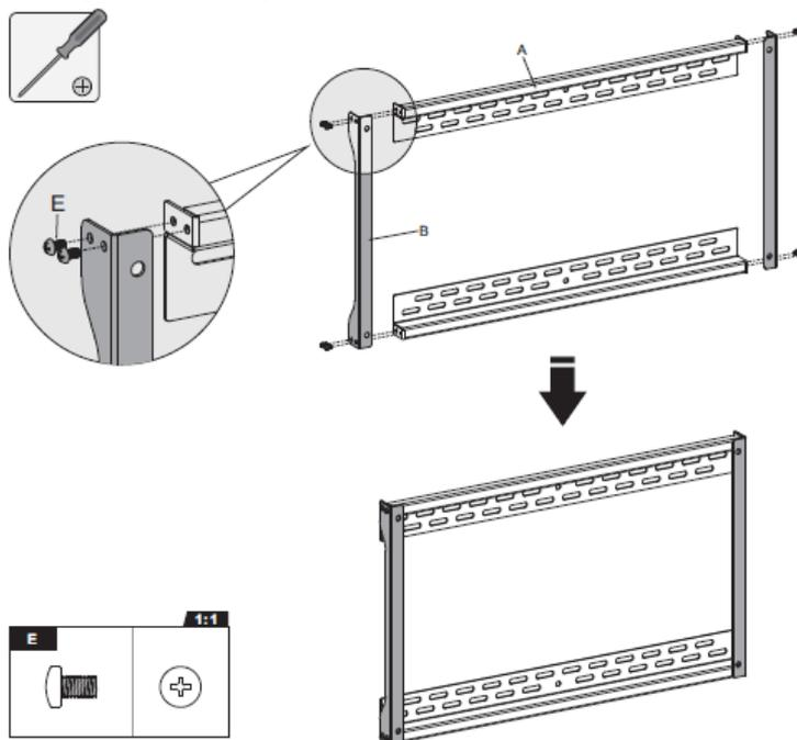
Fissare le piastre di collegamento alle piastre a parete utilizzando le viti apposite.
