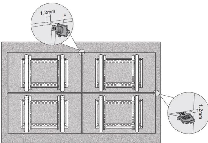
**Nota:** Utilizzare l'elemento di blocco in plastica per misurare e mantenere una distanza di 1,2 mm tra i display.
