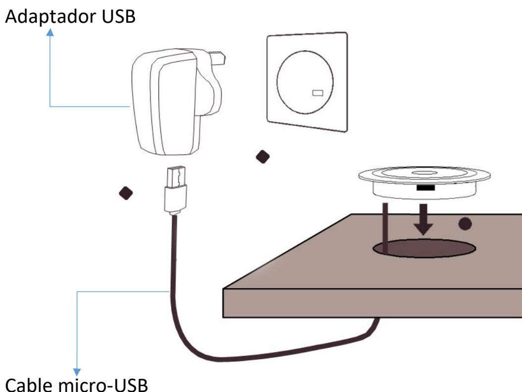
1. Encaje el cargador inalámbrico en la mesa, presionando con suavidad hasta que quede completamente enrasado con el escritorio.
