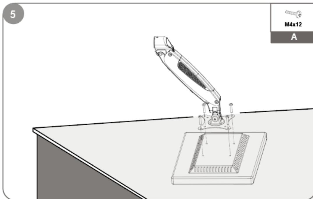
Montaggio a filo: fissare 4 viti attraverso il pannello anteriore tramite i fori di montaggio sul monitor.
