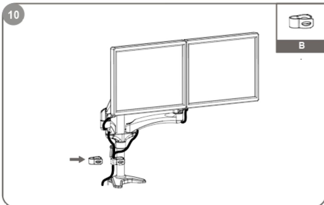
Inserire i cavi nei copricavi. Utilizzare i fermacavi per limitare i cavi in prossimità del tubo d'acciaio.
