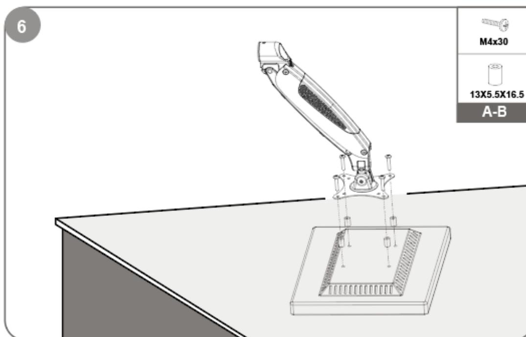
Installazione sulla superficie: posizionare 4 distanziali tra il pannello frontale e il monitor. Fissare 4 viti attraverso il pannello anteriore e i distanziali sui fori di montaggio del monitor.
