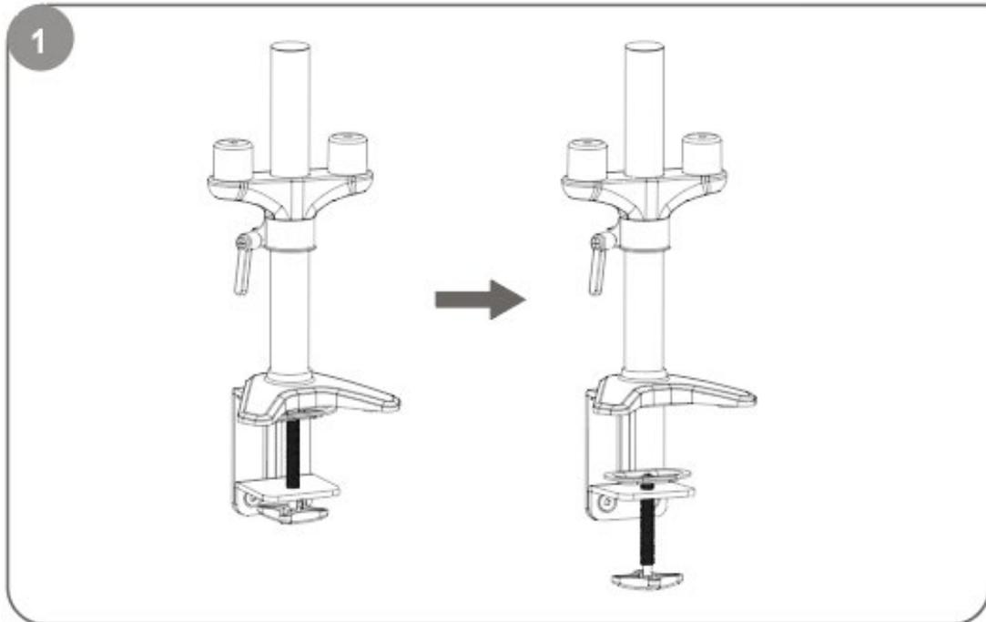
Desserrez la vis de serrage jusqu'à ce qu'il y ait suffisamment de place pour le bord de la table.
