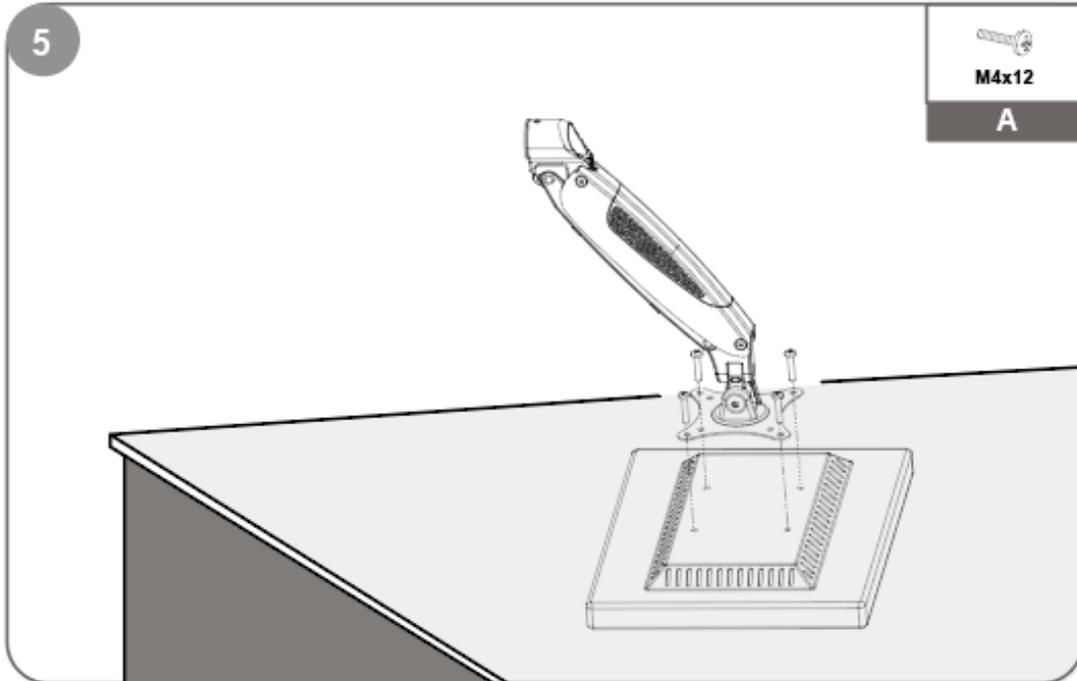
Montage affleurant: installez 4 vis à travers la plaque frontale sur les trous de fixation du moniteur.
