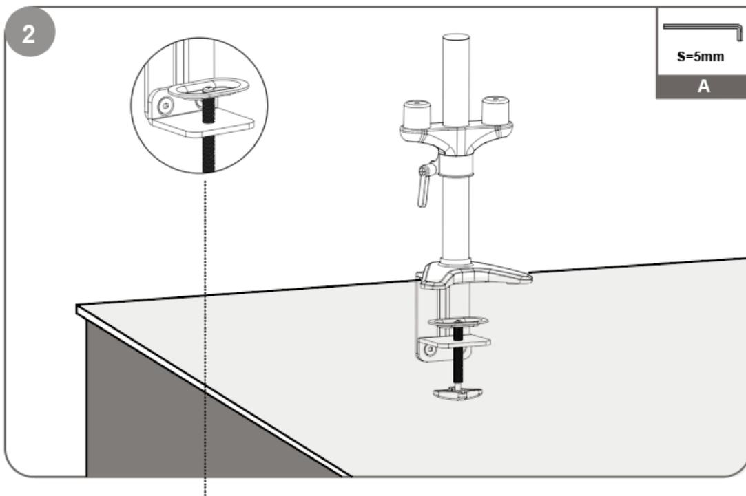
**REMARQUE: s'il n'y a toujours pas assez de place pour l'agrafe, retirez complètement la vis de l'agrafe et l'embout, puis remettez la vis de l'agrafe en place avec l'embout vers le bas.**
