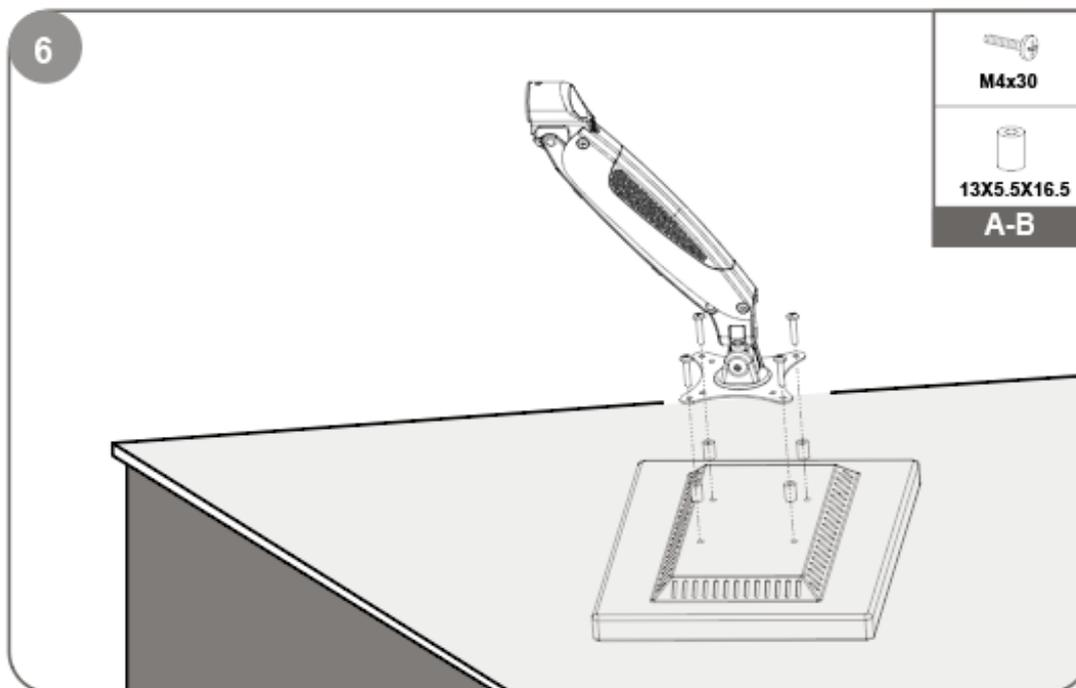
Einbau in die Oberfläche: Legen Sie 4 Abstandshalter zwischen Frontplatte und Monitor. Bringen Sie 4 Schrauben durch die Frontplatte und die Abstandshalter über die Befestigungslöcher am Monitor an.
