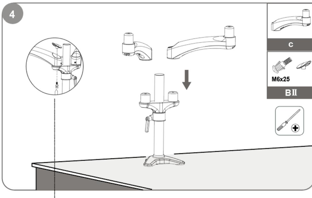
**Stecken Sie die Schraube durch das Loch vom Trägerteil in die Zierkappe.**
