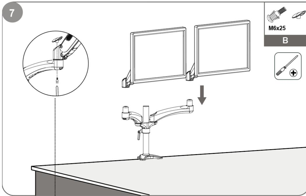
**Stecken Sie die Schraube durch das Loch vom Ausleger in die Zierkappe.**
