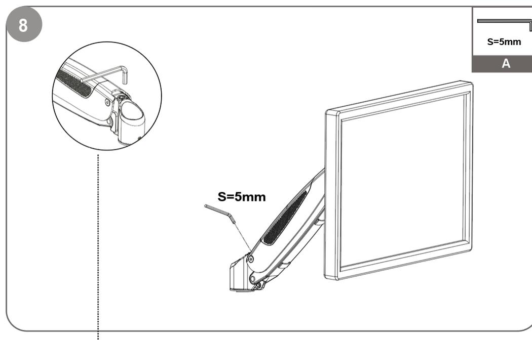
**HINWEIS: Drehen Sie im Uhrzeigersinn, um die Spannung für leichtere Monitore zu verringern, und gegen den Uhrzeigersinn, um die Spannung für schwerere Monitore zu erhöhen.**
