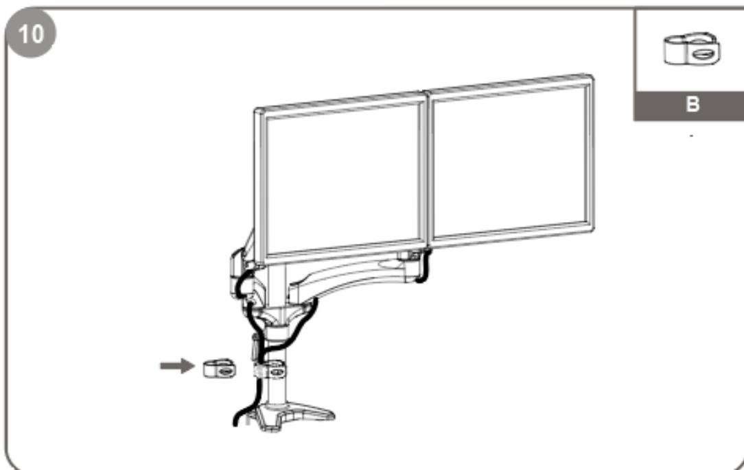
Führen Sie die Kabel in die Kabelabdeckungen ein. Verwenden Sie Kabelschellen, um die Kabel in der Nähe des Stahlrohrs zu begrenzen.
