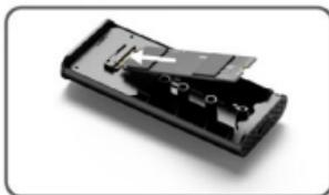
3. Drücken Sie die M.2-SSD vorsichtig nach unten. Verwenden Sie ein Silikonpad, um die Schließe auszurichten. Drehen Sie sie fest, um die Festplatte zu sichern.
