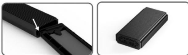
**Hinweis:** Auf beiden Seiten der Festplatte mit einer Kapazität von 1 TB oder mehr befinden sich Chips. Während der Installation werden die elektronischen Komponenten, die am M.2-Steckplatz auf der Platine angebracht sind, zusammengedrückt. Eine gewaltsame Installation führt zu physischen Schäden an der SSD. Bitte erzwingen Sie den Einbau nicht.
