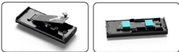
4. Kippen Sie die Ecke der inneren Halterung mit dem Verschluss um 45° und drücken Sie sie in das äußere Gehäuse der Festplatte. Richten Sie sie auf und setzen Sie sie wieder in das Gehäuse aus Aluminiumlegierung ein, drücken Sie sie ganz hinein, bis Sie die automatische Verriegelung hören. Sie haben die Installation abgeschlossen.
