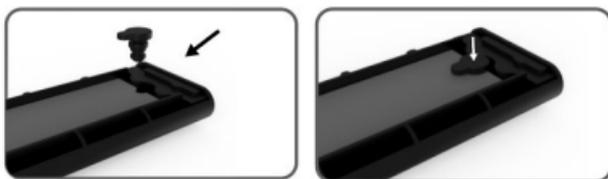
4. Drücken Sie die M. 2 SSD vorsichtig nach unten, richten Sie den Schnappverschluss mit dem Silikonpolster aus, drehen Sie die Festplatte und ziehen Sie sie fest.
