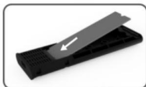
3. Richten Sie die Festplatte mit dem inneren Tray-Anschluss aus, setzen Sie die Solid-State-Festplatte sicher ein und stellen Sie sicher, dass die Festplatte mit dem M. 2-Anschluss ausgerichtet ist.
