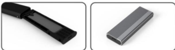
5. Kippen Sie die Ecke der inneren Halterung mit Schnappverschluss um 45°, drücken Sie sie in das äußere Gehäuse der Festplatte, setzen Sie sie in der positiven Position in die Aluminiumlegierung zurück, drücken Sie sie nach unten, bis die automatische Verriegelung zu hören ist, dann kann die Installation abgeschlossen werden.
