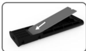
3. Allineare il disco fisso con il connettore del vassoio interno, inserire saldamente il disco fisso a stato solido e assicurarsi che il disco fisso sia allineato con il connettore M. 2.
