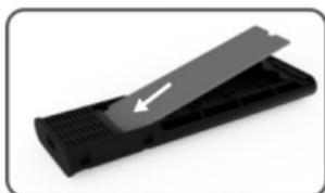
3. Alignez le disque dur avec le connecteur du tray, insérez le disque dur SSD en toute sécurité et assurez-vous qu'il soit connecté au connecteur M.2
