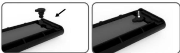
4. Appuyez doucement sur le SSD M.2, puis alignez le loquet avec le tampon en silicone, faites pivoter le disque dur et serrez.
